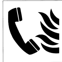
消火用非常電話
