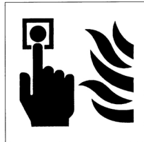
消火用非常ボタン
