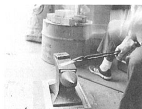
③熱しては鍛き、という作業を繰り返す。鉄を鍛きのばしながら同時に成形していく。
