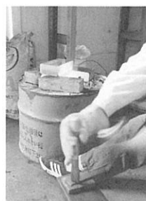
⑦タガネで先端を切り、刀角度を作る。
