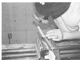
⑨成形を行い、刻印用のタガネで銘を彫り込む。裏刃側は、リューターと砥石で線ガケする。
