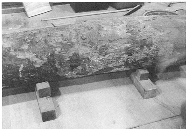
① 原木を横にした状態で、バンコの上に置き、材が転がらないように楔で止める。
