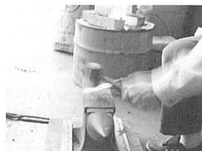
⑥鍛いて、地金と鋼を完全に接着し、成形していく。
