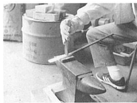
②火床で十分に熱し、必要な長さのところで、タガネで切る。
