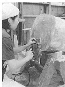
⑪ チェーンソーで切った面は荒いので鉋をかけるが、作業し易い様に馬に乗せたりする。
