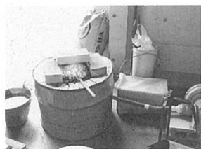
①ドラム缶を利用して作った火作り。釜に送風器を取り付け、細かく砕いたコークスを入れ、耐火レンガで囲み、火作り場とする。
