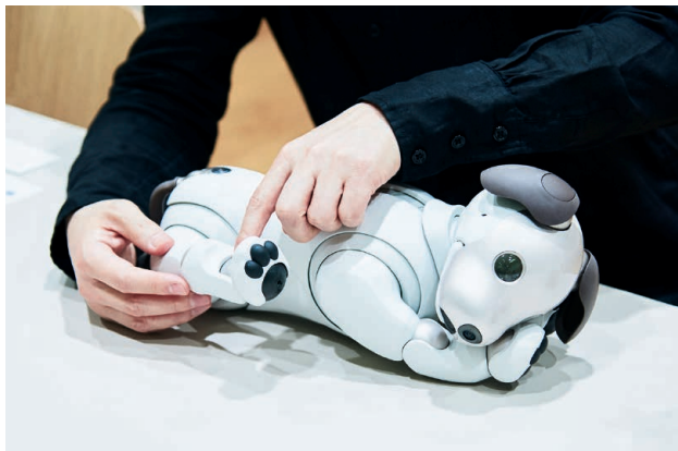
高木さんがデザインを手がけた、aibo「ERS-1000」。これまでのaiboとの大きな違いは、腰が動き、後ろ足の返しが追加されたことで、より自然な動きが可能となったこと。高木さんが求めたデザインと機能を最新の技術で実現した。
