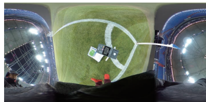
上=ヘリコプターで見た景色そのままに開発されたスタジアムの外観画面。遠くの街並みまで見事に再現。下=光の強さを計測する照度計という機器で照度を計測しつつ、スタジアムの環境を360度撮影。
