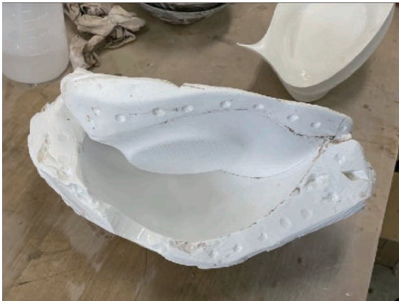
3Dプリンターで原型を出力し、石膏形を作る Make the plaster mold based on the 3D print
