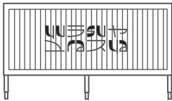
コンテナから脚が伸びてきて、自立する。トラックが去る。 Its legs extend and it can stand by itself. The truck leaves.
